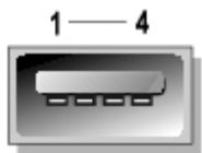
Figure B-7. Numéros de broches pour le connecteur USB
